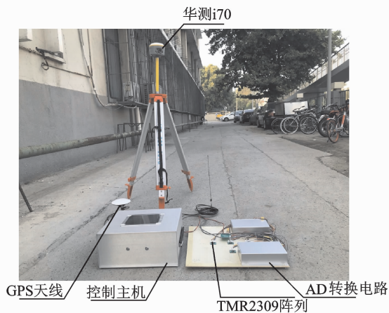
图5 磁梯度张量检测系统
