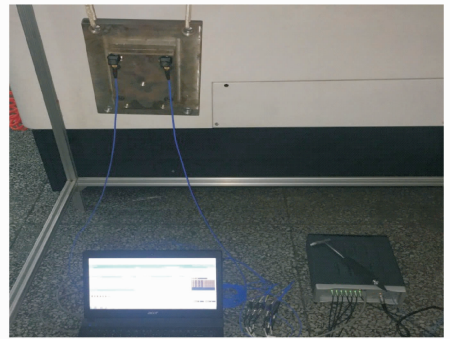
图 14 锤击法模态试验
