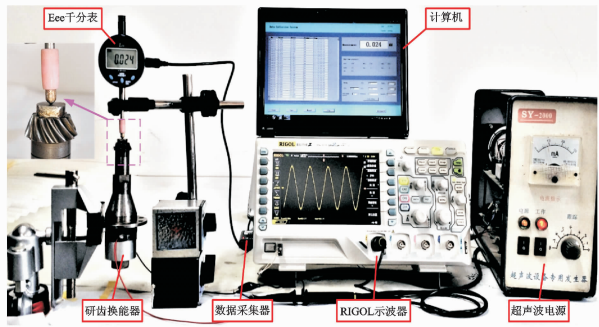
图8 研齿换能器的振幅测试
