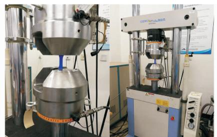
图 4 拉伸实验设备(液压伺服)和样件
