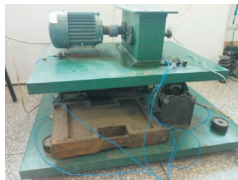
图17 发动机动力总成悬置系统模拟台架
