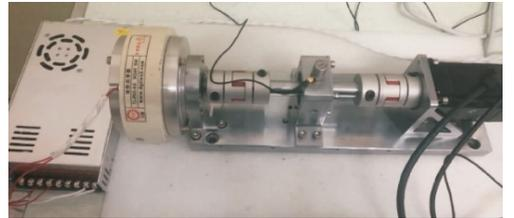
图10 滚动轴承振动测试试验台
