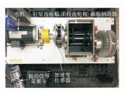
图 5 动力传动故障诊断综合实验台
