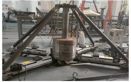
图 10 直升机主减隔振系统模型
