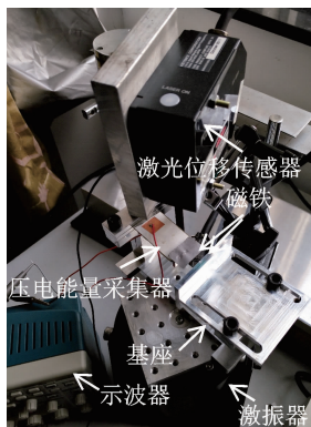
图 7 三稳态压电能量采集器实验测试平台
