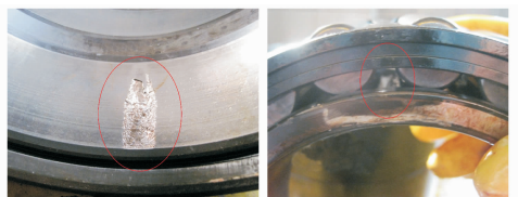
图 4 试验用轮对轴承外圈和内圈故障
