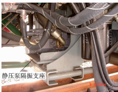
图10 隔振系统实验照片
