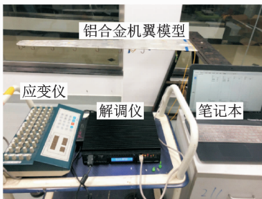
图 6 基于 FBG 传感器的应变场重构系统
