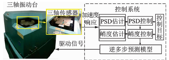
图 2 三轴非高斯随机振动试验
