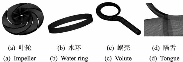
图 2 离心泵流道网格划分图
