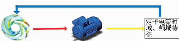
图 1 基于电机电信号监测泵状态原理
