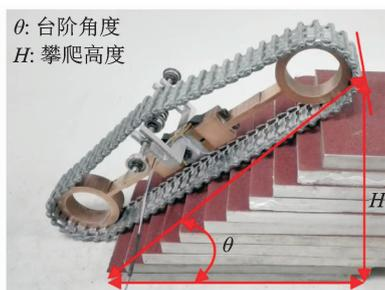
图 13 原理样机攀爬台阶示意图
