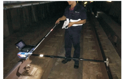
图 2 钢轨表面纵向不平顺现场测试图
