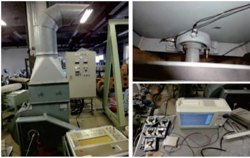
图 6 滚动轴承故障诊断实验平台
