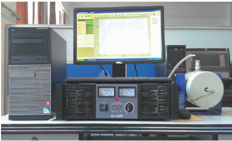
图 3 激振器及其控制系统 Fig. 3 Shaker and control system
