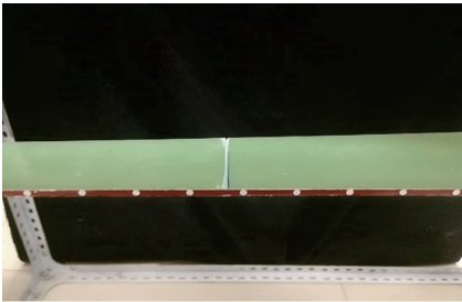
图 11 小型复合材料叶片裂纹设置 Fig. 11 Characteristic points and crack setting of blade
