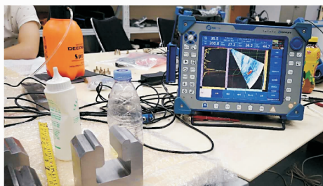
图 4 全聚焦相控阵超声检测设备
