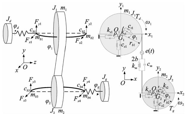
图 1 齿轮系统动态模型
