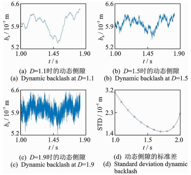
图5 动态侧隙  $b_h$  和动态侧隙的标准差  $(b_h)_{STD}$
