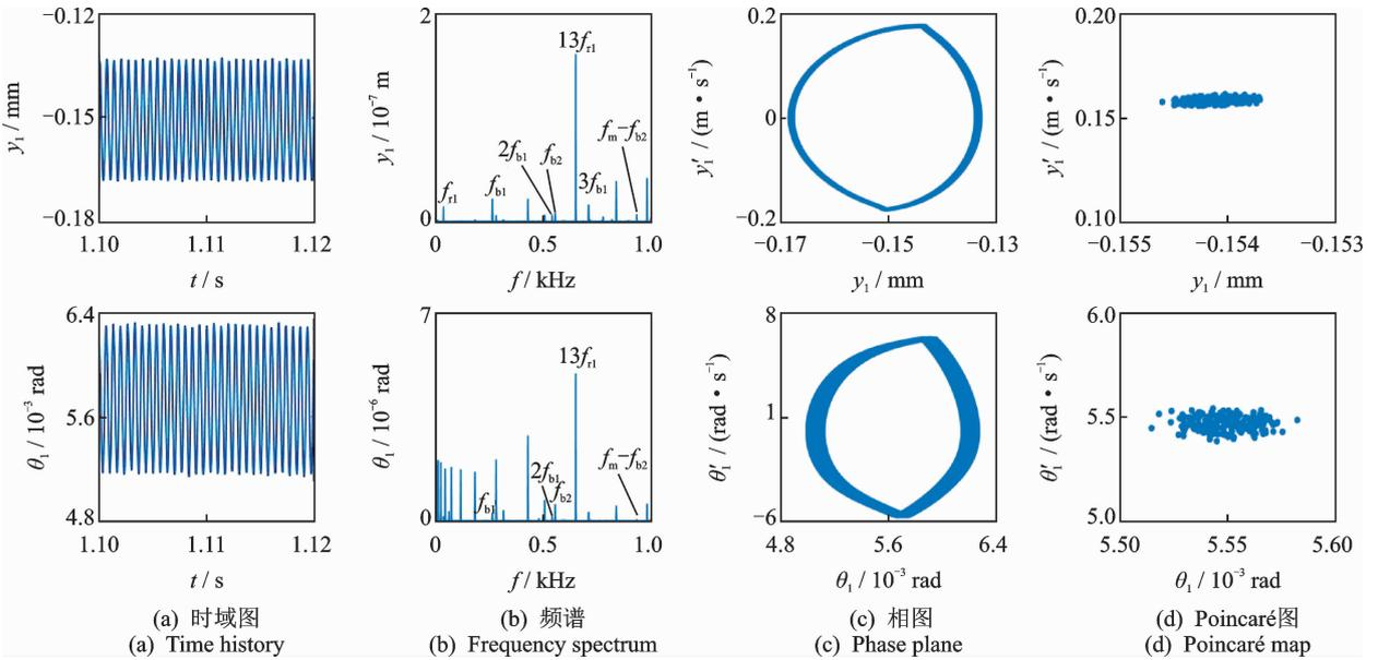
图 10  $D = 1.9$  时的振动响应
