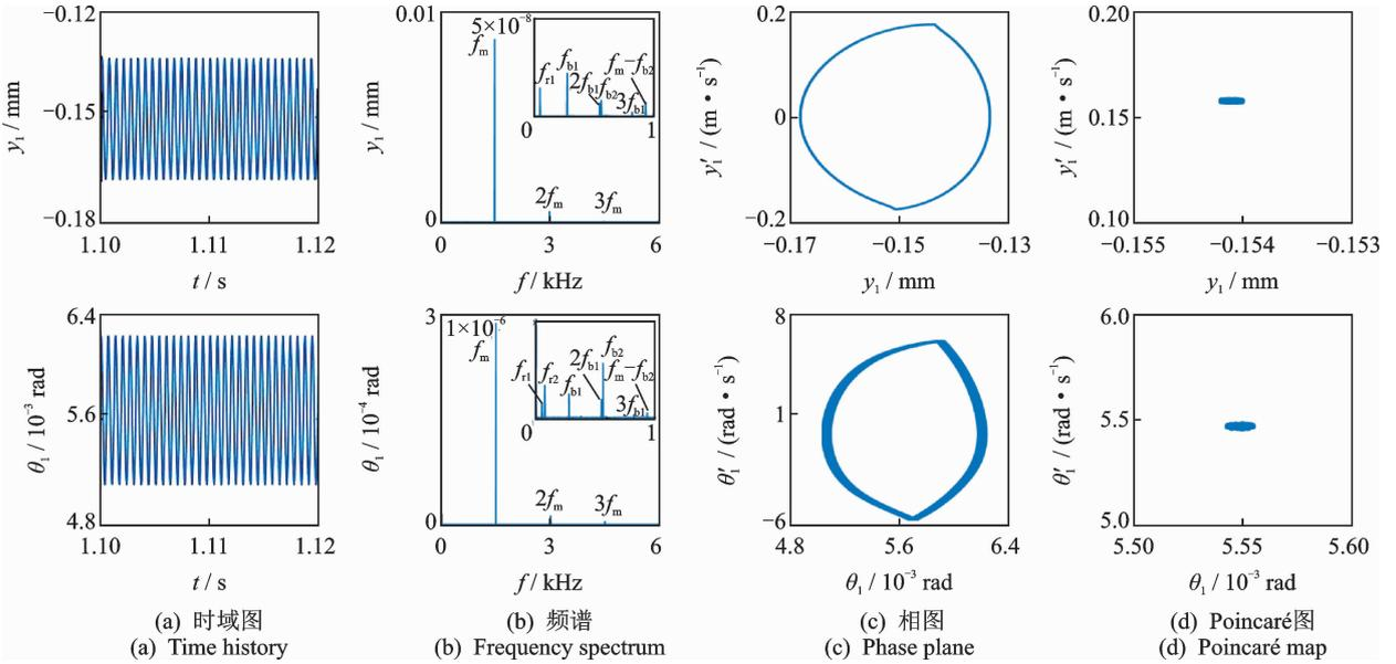
图 7 定侧隙的振动响应
