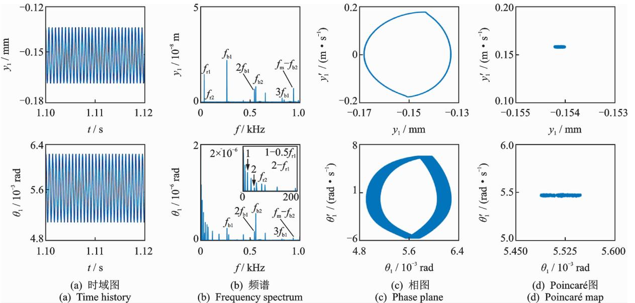
图 8  $D = 1.1$  时的振动响应
