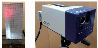
图 2 平板试验装置与激光测振仪
