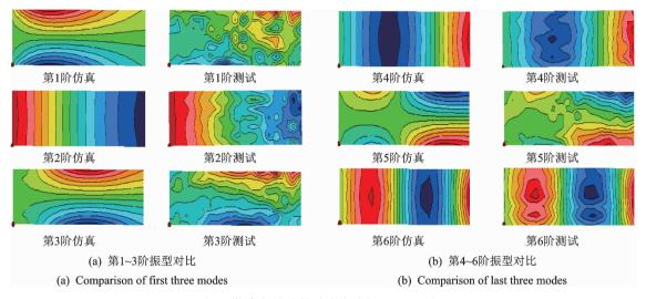
图 8 仿真与试验转动自由度振型  $(\theta_x)$  对比
