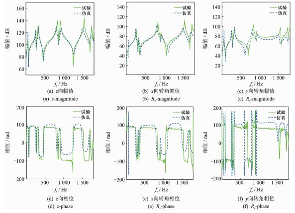
图 5 原点频响函数仿真与试验对比
