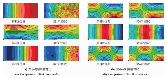
图 9 仿真与试验转动自由度振型  $(\theta_y)$  对比
