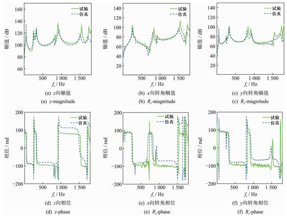
图 6 跨点频响函数(139点激励,70点响应)仿真与试验对比
