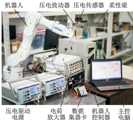
图 2 压电柔性臂测控系统实物图
