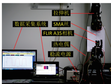
图5 SMA丝作动特性试验平台
