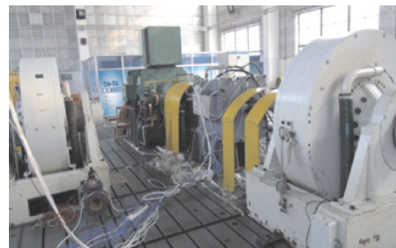
图 2 行星变速机构振动加速度试验测试系统
