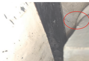
图2 变桨轴承的外圈裂纹
