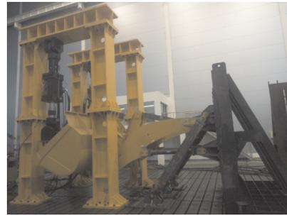
图 6 LW900K 装载机工作装置应力标定试验台
