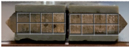
图10 模态试验测点网格图
