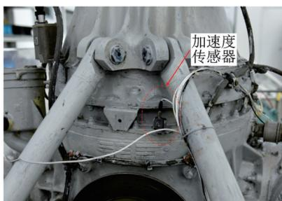
图 5 直升机行星传动轮系实验验证平台
