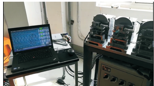
图12 微型调心球轴承摆动工作特性试验台
