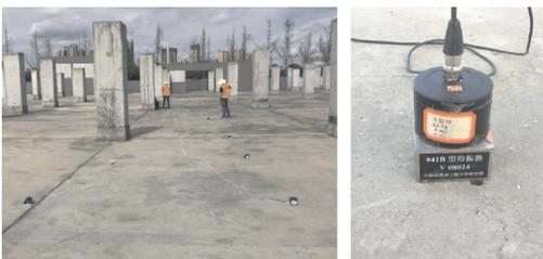
图6 平台盖板测点现场布置图
