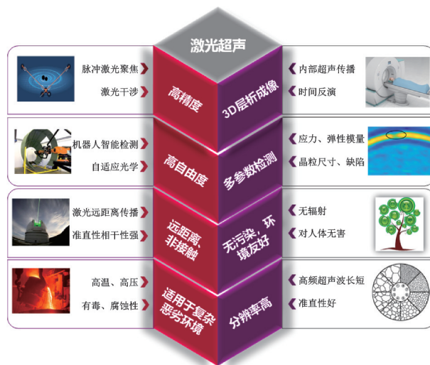
图 4 激光超声无损检测的优势
