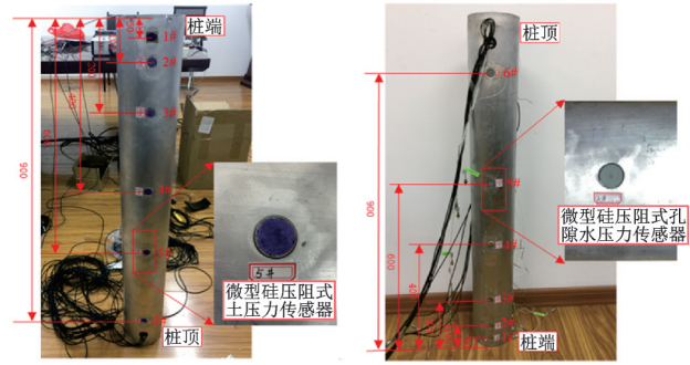
(a) 土压力传感器 (b) 孔隙水压力传感器 (a) Earth pressure sensors (b) Pore water pressure sensor
