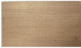
图2 共固化后的 CSDC 板
