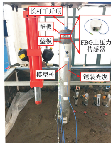
图3 桩顶FBG土压力传感器布置
