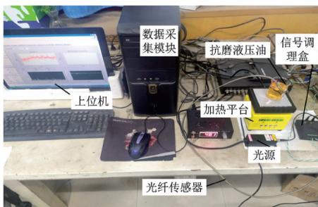
图9 反射式光纤传感器测温实验台
