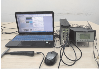
图 7 B&K 振动测试仪器 Fig.7 B&K vibration tester
