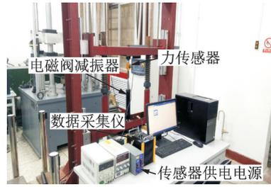
图 3 电磁阀减振器速度特性试验
