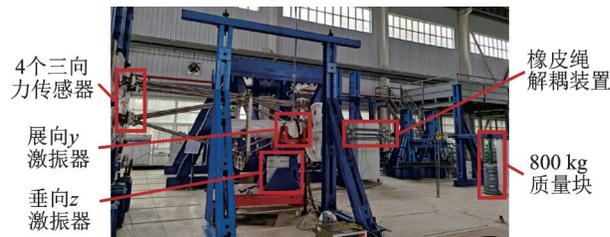
图 6 涡桨发动机隔振性能试验平台
