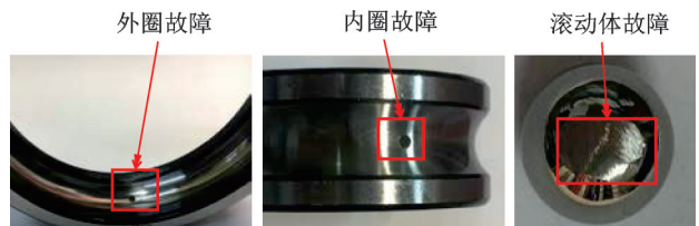
图 5 实验轴承的 3 种故障情况
