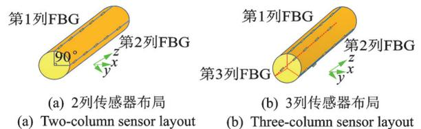
图3 杆状结构传感器布局方式
