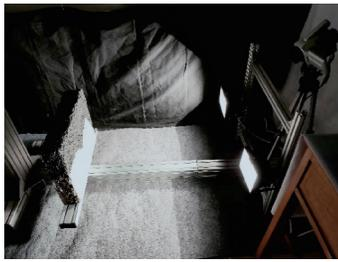
图9 基于主动激励红外图像的煤岩界面识别实验
