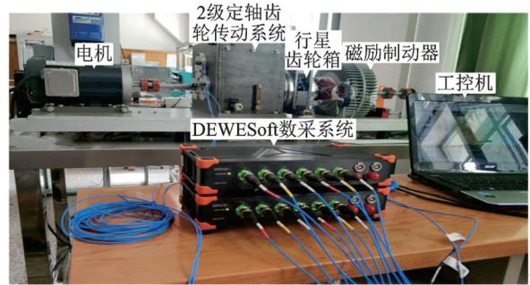
图 7 故障诊断综合试验平台
