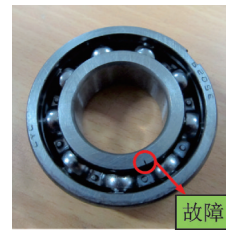
图 9 轴承内圈故障
