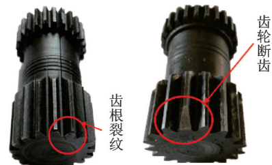
图 7 太阳轮故障件
