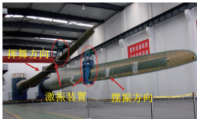
图 6 单轴疲劳加载试验 Fig.6 Uniaxial fatigue loading test
