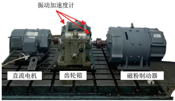
图 4 齿轮箱实验台实物图
