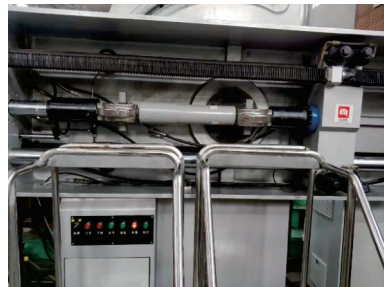
图5 悬挂元件性能测试试验台SPTB-100
