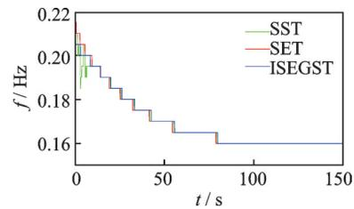
图 3 Duffing 系统位移响应的瞬时频率
