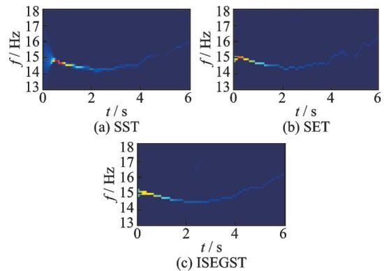
图 16 拉力正弦变化的时频图
