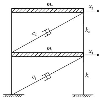
图 4 两层剪切框架结构
