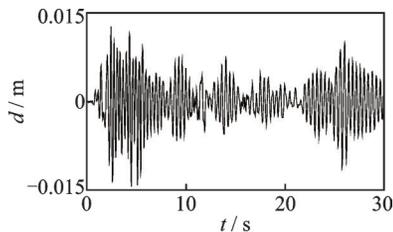
图 5 EL-Centro 地震波激励下第 1 层位移响应
