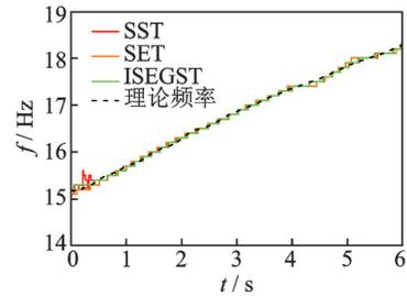
图 13 拉力线性变化的频率识别结果
