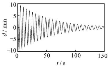
图 1 Duffing 系统的位移响应
