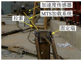
图 9 拉索试验装置
