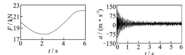
图 14 实测正弦变化的拉力
