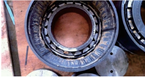
图 9 轮对轴承外圈人工缺陷
